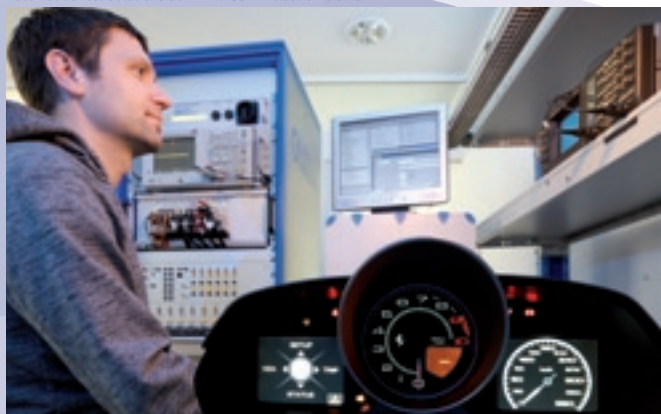
Funktionstest von Steuergeräten aus dem Bereich Automotive Test Solutions der Firma GÖPEL electronic GmbH
