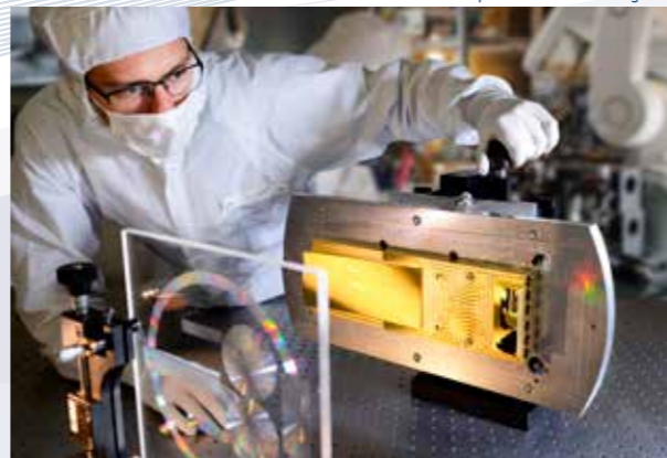
© Fraunhofer IOF: Messung eines Spiegelmoduls mit zwei Freiformspiegeln und Referenzstrukturen durch ein Computer Generiertes Hologramm
