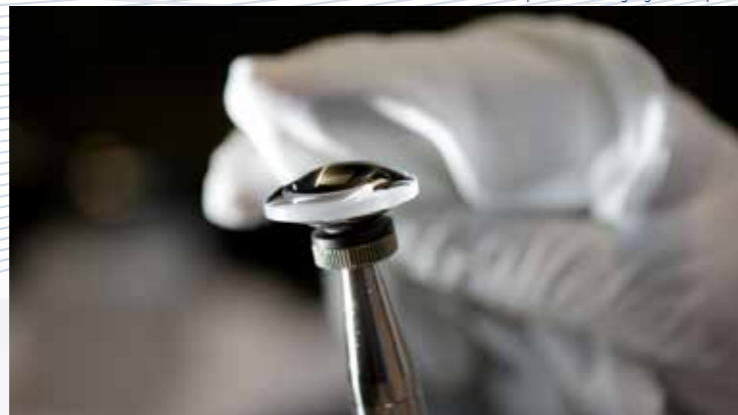
© asphericon: Reinigung einer Asphäre
