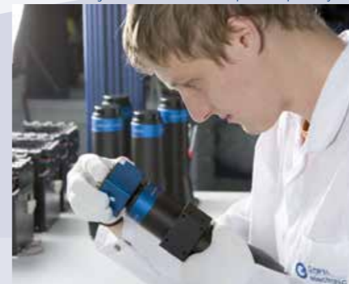
© GÖPEL electronic GmbH: Montage eines Kameramoduls für ein optisches Inspektionssystem
