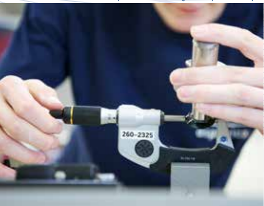
© asphericon: Vermessung einer asphärischen Optik
